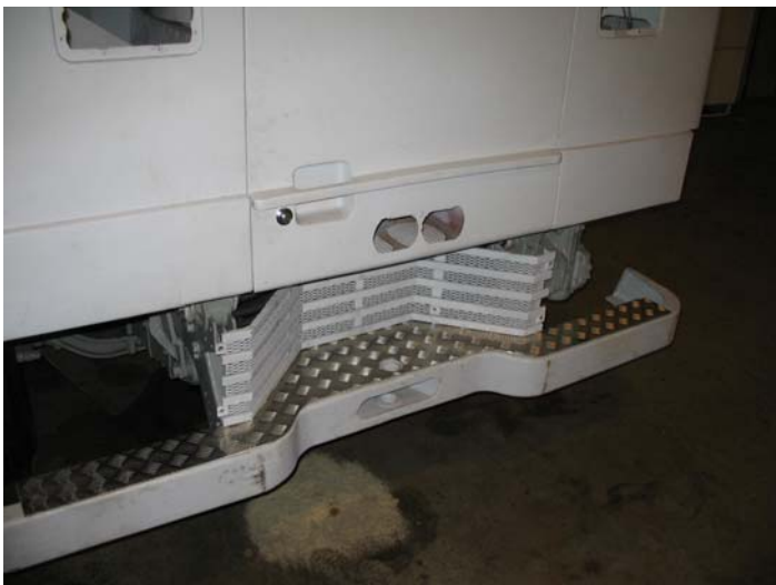
Vänstra bilden. Nytt insteg tillverkad i durkaluminium
