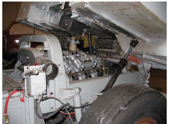
Högra bilden. Hyttkraften renoverad och monterad
